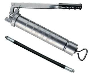
**Bomba engrase a palanca.** DIN 1283. Tubo 1 mm. Pistón 8 mm. Rosca 1/8" GAS. Bomba engrase 500 cm³. Latiguillo poliamida y boquilla. Para utilizar con cartuchos de grasa 400 gr (DIN 1284) o grasa a granel.
