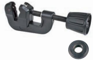
**Cortatubos profesional.** Cuchilla telescópica. Cuchilla escariadora retráctil. Rulina de repuesto en el pomo. 4 rodillos para optimizar el agarre del tubo. Para tubos de cobre, latón, aluminio y acero de paredes delgadas.
