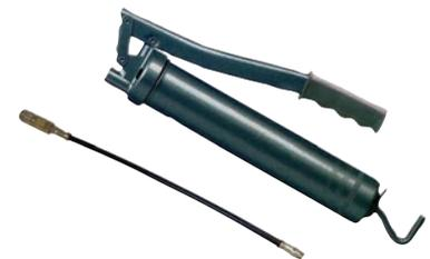
**Bomba de engrase a palanca (pistola).** DIN 1283. Pistón 8 mm. Rosca 1/8" GAS. Bomba de engrase 500 cm³. Latiguillo reforzado y extensión rígida con boquilla. Para utilizar con cartuchos de grasa 400 gr (DIN 1284) o grasa a granel.
