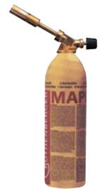
**Soplete Rofire Piezo.** Encendido piezoeléctrico. Múltiples aplicaciones de fontanería profesional, instalación, etc. Llama concentrada tipo dardo. Quemador  $\varnothing$  22 mm. Capacidad de trabajo a 360° previo calentamiento 2 minutos.
