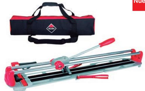
**Cortador azulejos FAST-65.** Nuevo conjunto separador más rígido y estable que facilita el rallado. Guías de acero cromado  $\varnothing$  18 mm con tratamiento anticorrosión. Tope lateral milimetrado y escuadra a  $45^\circ$ . Rodeles intercambiables de  $\varnothing$  6 a 10 mm. Rodel  $\varnothing$  6 mm incluido. Base con efecto amortiguante. Bolsa de transporte.
