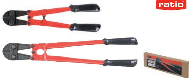
**Cortavarillas.** Cuchillas acero cromo-molibdeno, dureza HRC59±3. Pernos excéntricos para ajustes de la mandíbula. Mangos tubulares con empuñaduras antideslizantes.
