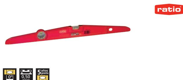
**Nivel antichoc.** Fundición de aluminio ultraligero. Dos burbujas acrílicas. Base de nivelación rectificada. Precisión 0,50 mm/m (0,0285°).
