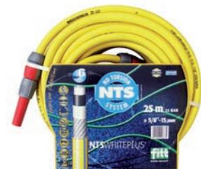
**Manguera riego tricapa tipo látex.** Atóxica y de uso alimentario. Temperatura de uso -10°C a +60°C. Refuerzo intermedio de malla de hilo de poliéster.
