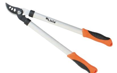
**Tijera podadora.** Corte deslizante (Bypass). Sistema de desmultiplicación de fuerza. Cuchilla recubrimiento antiadherente. Brazos tubulares de aluminio. Empuñaduras ergonómicas antideslizantes.
